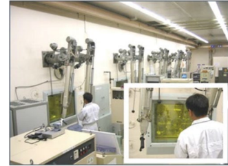
マイナーアクチノイドを扱う設備例（ホットセル）
