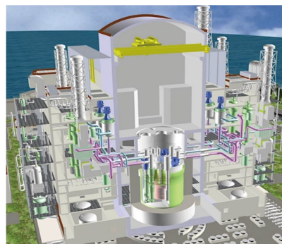
図 8-5 ナトリウム冷却 タンク型高速炉
