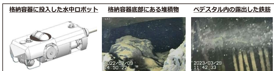
図 1-42 原子炉格納容器内部調査装置(水中ロボット)及び調査画像
