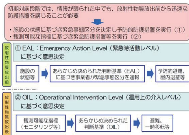
図 1-33 防護措置実行の意思決定の枠組み
