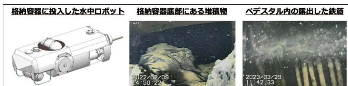
図 6-6 原子炉格納容器内部調査装置(水中ロボット)及び調査画像
