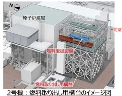
図 6-5 1号機（左）及び2号機（右）における燃料取り出し工法の概要
