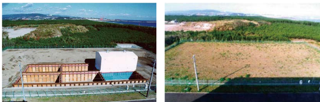
図 6-18 原子力機構の埋設実地試験における埋設段階(左)及び保全段階(右)の様子 (出典)原子力機構「埋設実地試験」
