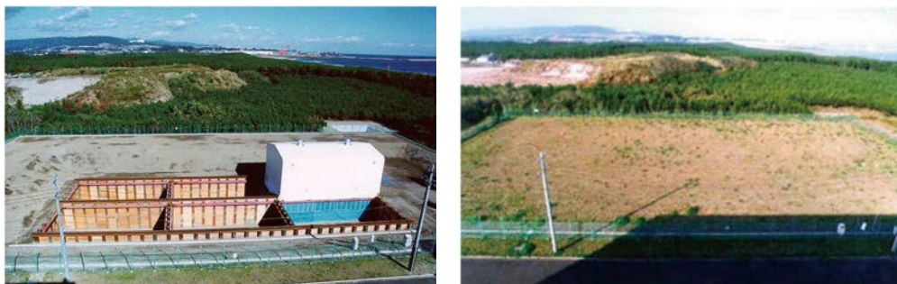
図 6-18 原子力機構の埋設実地試験における埋設段階（左）及び保全段階（右）の様子
