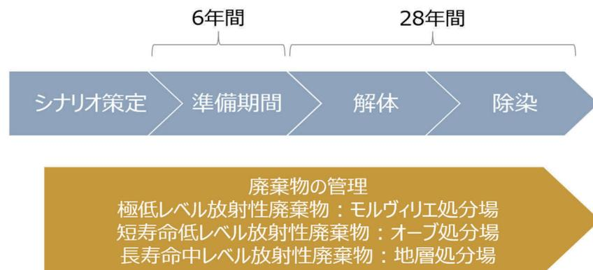
図 15 フェニックスの廃止措置の流れ
