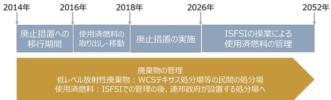
図10 即時解体によるバーモントヤンキー炉の廃止措置計画
