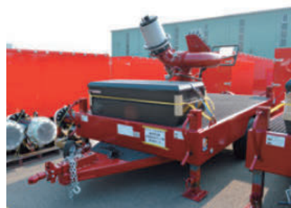
屋外放水設備
