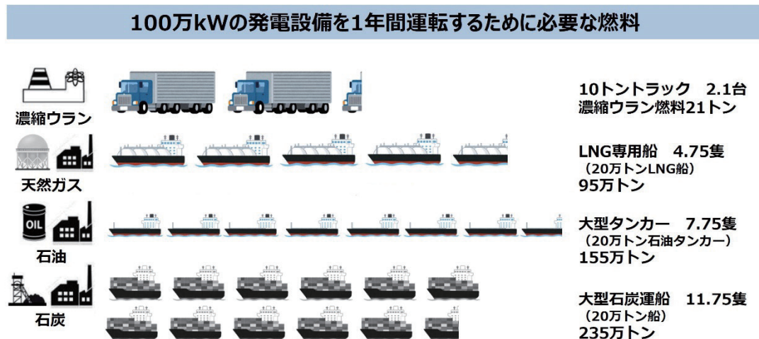
図 2-25 百万 kW の発電設備を 1 年間運転するために必要な燃料
