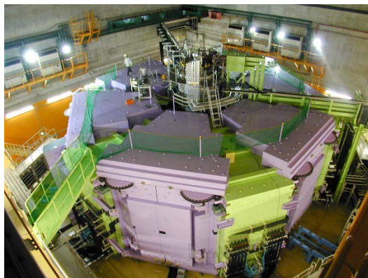
図 3-22 RI ビームファクトリー (RIBF) 超伝導リングサイクロトロン
