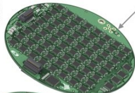
炉内未臨界モニター(中性子検出器)の概念図
