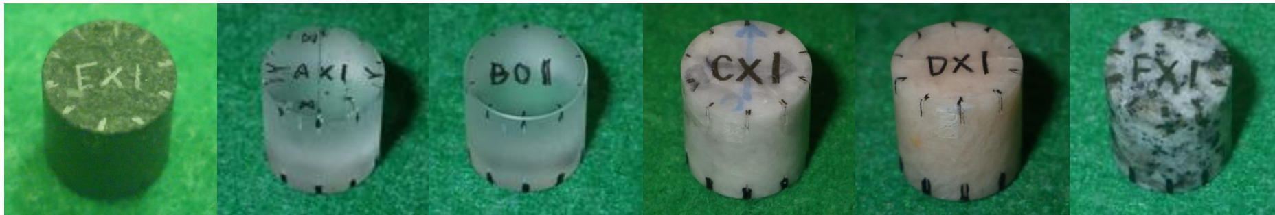
熱変性凝灰岩
