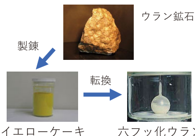
図7 ウラン鉱石、イエローケーキ及び六フッ化ウラン
