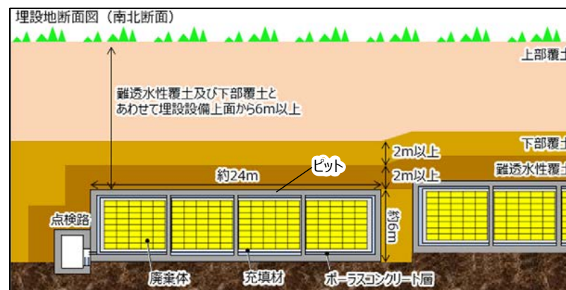
低レベル放射性廃棄物埋設設備の構造（ピット処分） （1号廃棄物埋設施設）
