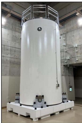
〈図-3〉 乾式キャスクの外観
