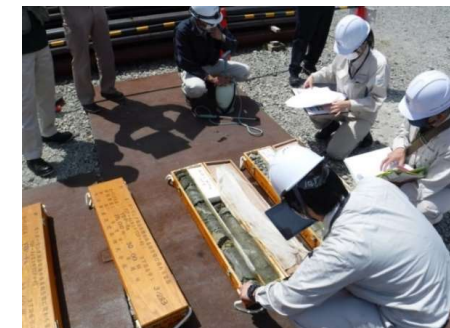
ボーリング孔の掘削・調査技術の実証 大深度ボーリング実証試験現場の様子（電中研との共同研究）
