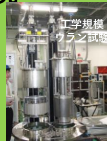
電解精製装置
