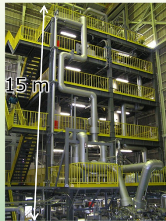
HUSTLE: 日立GEベルノバ が所有する世界最大規模の BWR実温実圧試験設備
