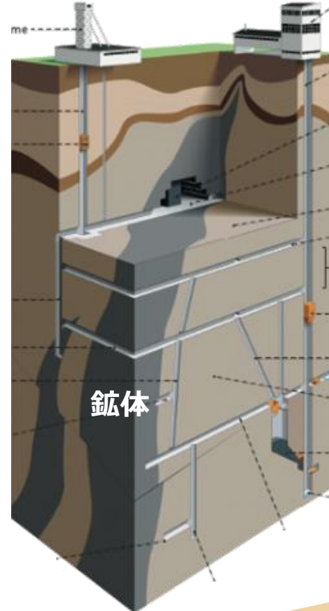
左図：坑内掘鉱山の模式断面図 (出典：National Research Council (2012) に修正・加筆))
