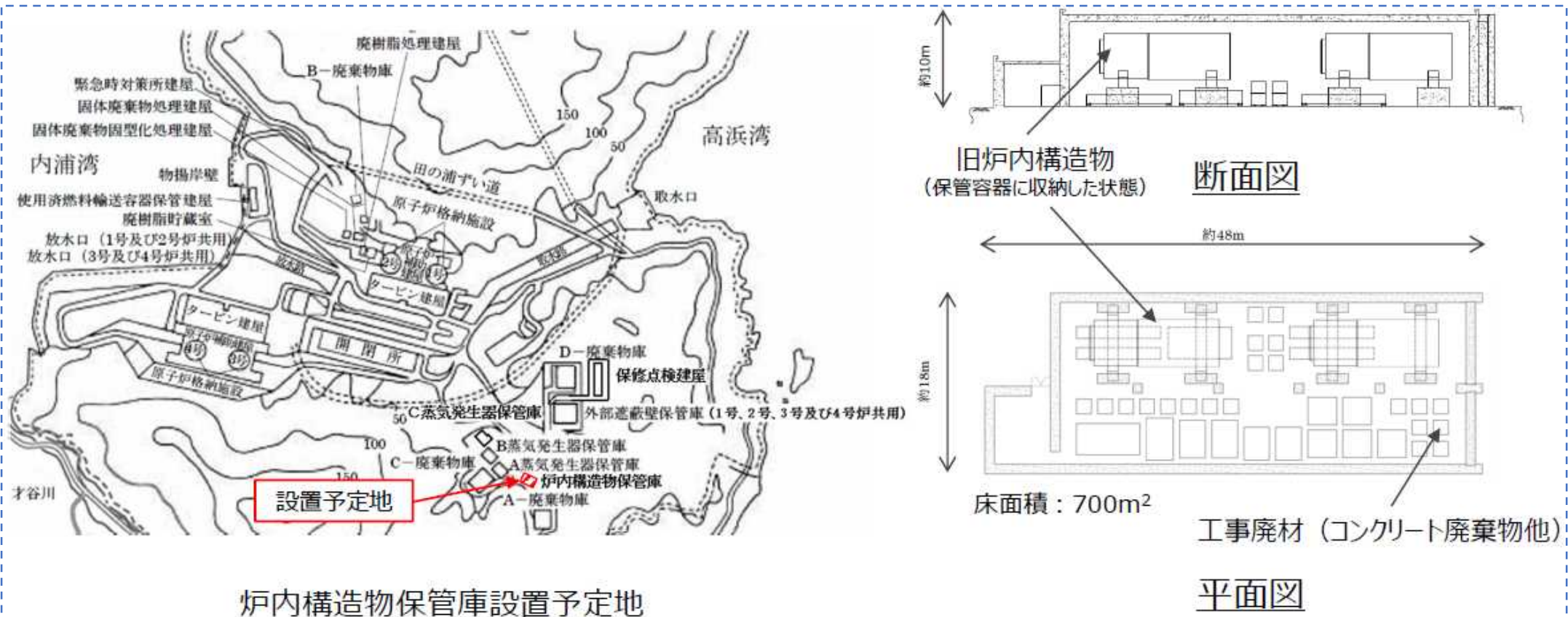
図3 炉内構造物保管庫の概要
