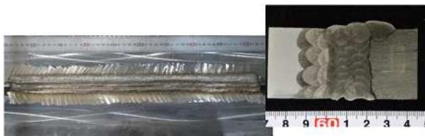
異材継手 溶接試験体
