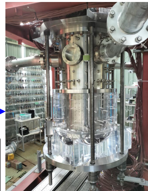
下部流動試験のスケールモックアップ (左図の青色領域が対象)
