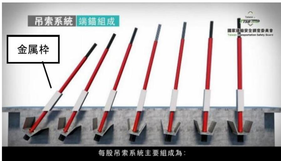
図-8 下端側定着構造の断面イメージ
