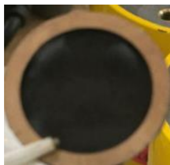
①直径33mmのDisk状線源 酸に溶けない \text{RaSO}_4
