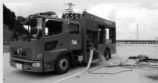
例) 代替注水用車両 写真提供: 中国電力(株)
