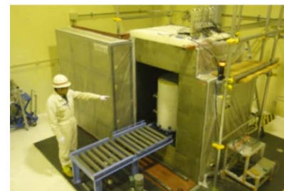
図4 人形峠に設置したウラン非破壊測定装置
