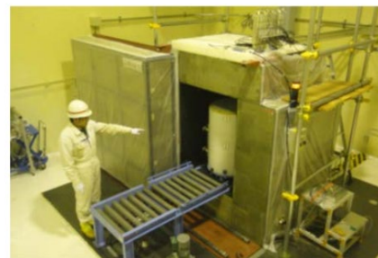
図4 人形峠に設置したウラン非破壊測定装置 JAWAS-N(JAEA Active Waste Assay System - Ningyo)
