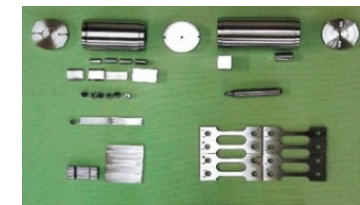
核融合炉材料照射試料
