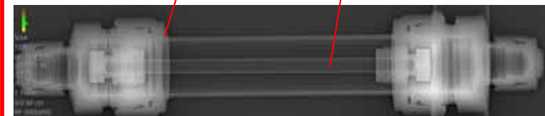
外側容器 組立品 (X線による透過写真)
