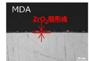
PWR冷却材模擬環境(360°C)腐食試験（未照射）結果
