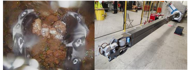
2号機格納容器の内部調査
