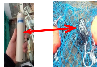
底水温計と底びき網への装着状況
