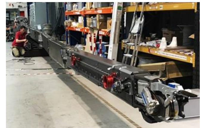
● 燃料デブリを取り出す ロボットアームを開発中 。
