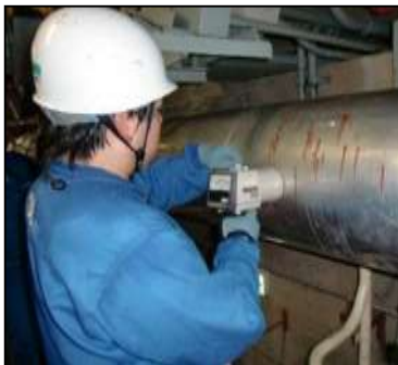
配管の線量当量率測定
