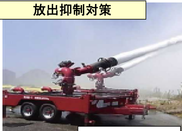
可搬型放水砲
