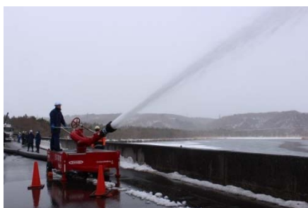
可搬型放水砲 対象となる施設などに放水し、 放射性物質の拡散を抑制
