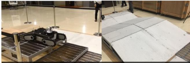
金属製環境での走行性能評価用試験場
