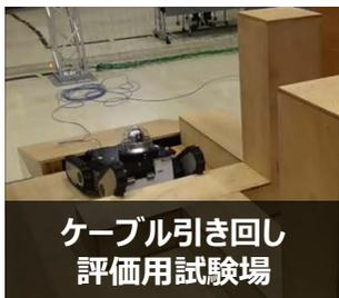
ケーブル引き回し評価用試験場
