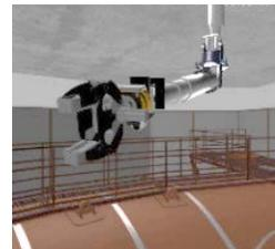
遠隔操作機（FRM）をVR上で操作訓練ができるシミュレータシステムを開発
