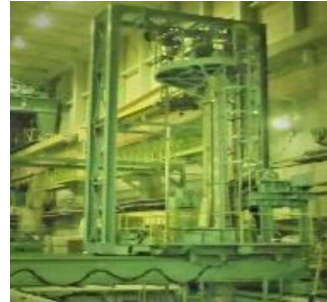
高経年化対策 燃料取出しプールクレーンの更新 (核燃料サイクル工学研究所)
