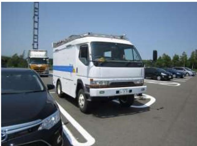
電源・運搬用車両（TV中継車の改造）
