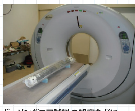
ボーリングコア試料の観察などに活用されているヘリカルX線CTスキャナ
