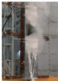
ケーブル火災時の自動消火設備消火性能試験
