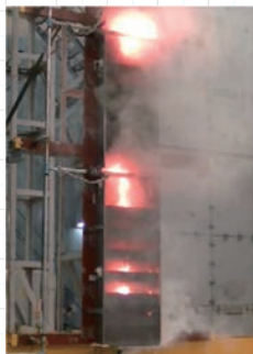
ケーブル火災時の自動消火設備消火性能試験
