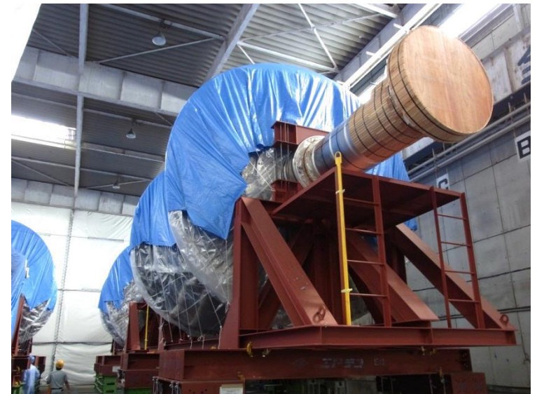
工場における保管状況例 (低圧タービンロータ)
