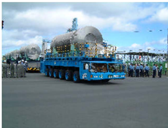
使用済み核燃料積載車両
