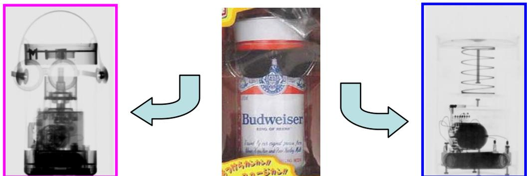
中性子は水素の多いプラスチックがよく写るが、金属は写らない。(金属を通り抜けている)
