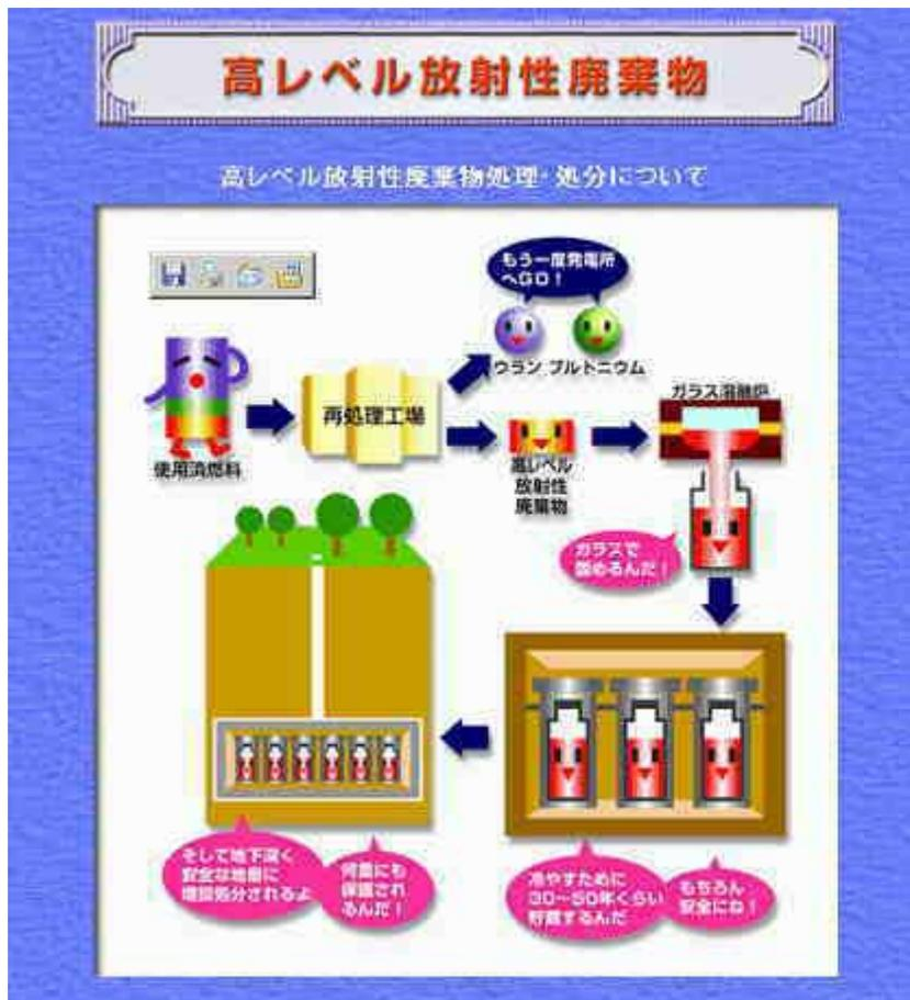
発電所で使い終わった燃料から、ウランとプルトニウムを取り除いた廃棄物を、高レベル放射性廃棄物といいます。高レベル放射性廃棄物は、長期間安定なガラスと混ぜてステンレス容器に注入。冷却して固めたガラス固化体は、30～50年施設に貯蔵されます。その後、地層の安定した場所に地中深く埋設処分される予定です。
