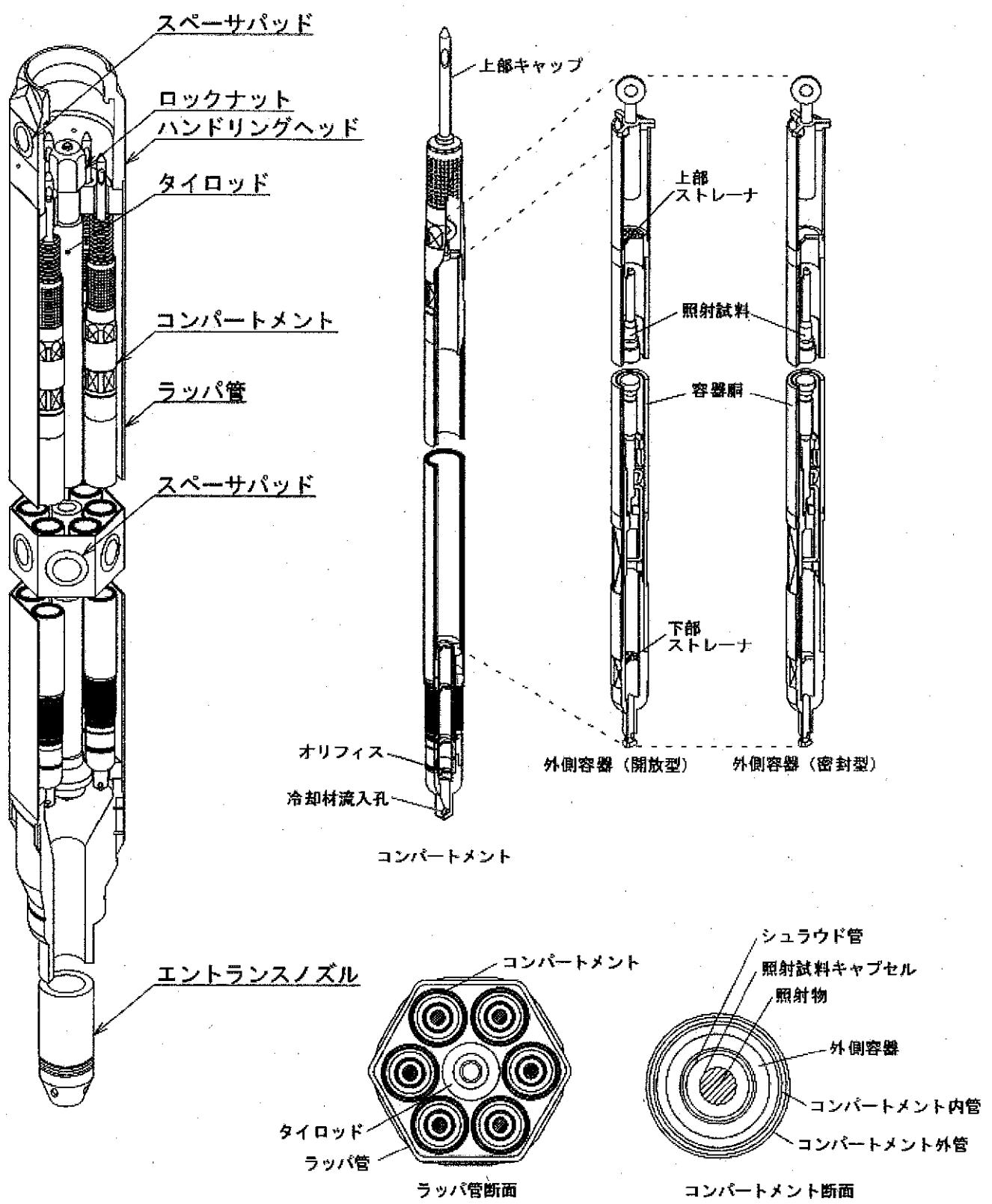
図-2 (1) 照射用実験装置例 (本体設備 1/2)
