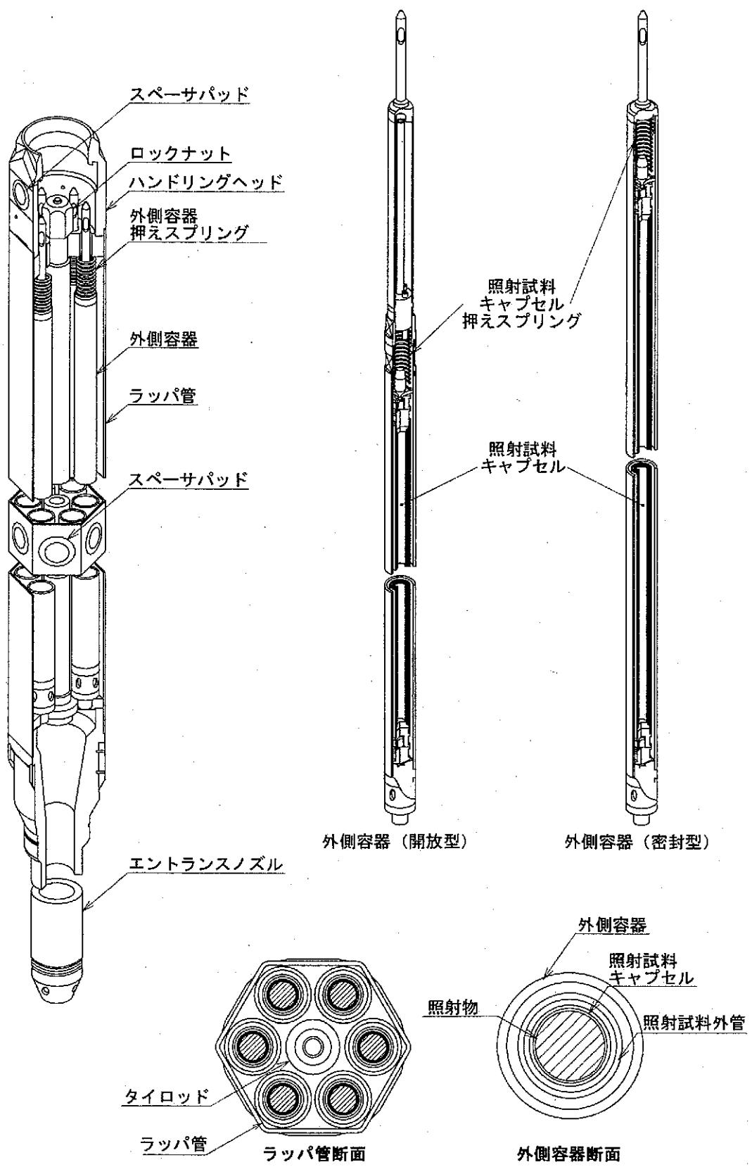
図-2 (2) 照射用実験装置例 (本体設備 2/2)
