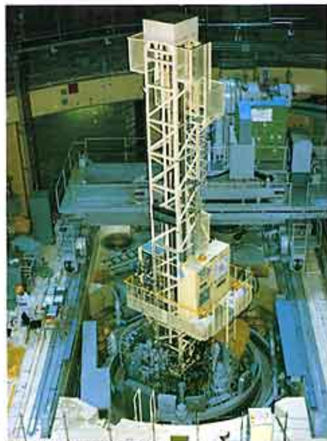
炉内ナトリウムシッピング法FFDL装置 The FFDL System using Wet Sipping Method
