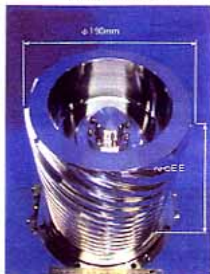
開発したヘリカル溝高速回転翼
