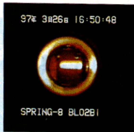
蓄積リングから発生した放射光 (中心の白い長方形が放射光)
