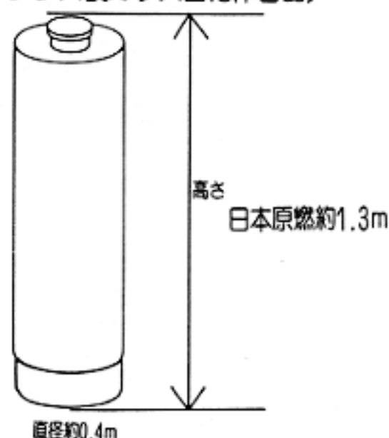
キャニスター (ステンレス製ガラス固化体容器)
