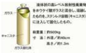
六ヶ所再処理工場では、ガラス固化体1体は約0.8t-Uの再処理により発生
