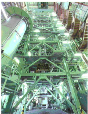
LSTFによる全交流電源喪失時などでの炉心冷却条件評価試験
