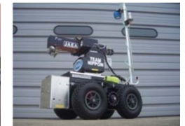
JAEA-3号 (屋内観察・γ線可視化ロボット)
