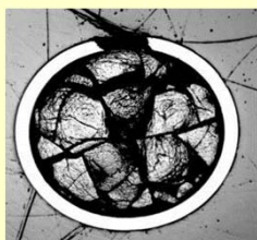
破損燃料の断面の分析
