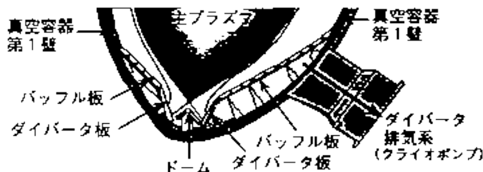
図1 JT-60 W型ダイバータの模式図
